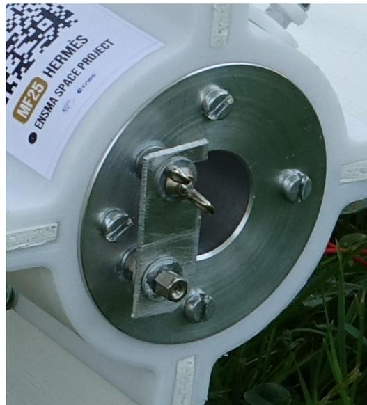
FIGURE 3 – Bague moteur
