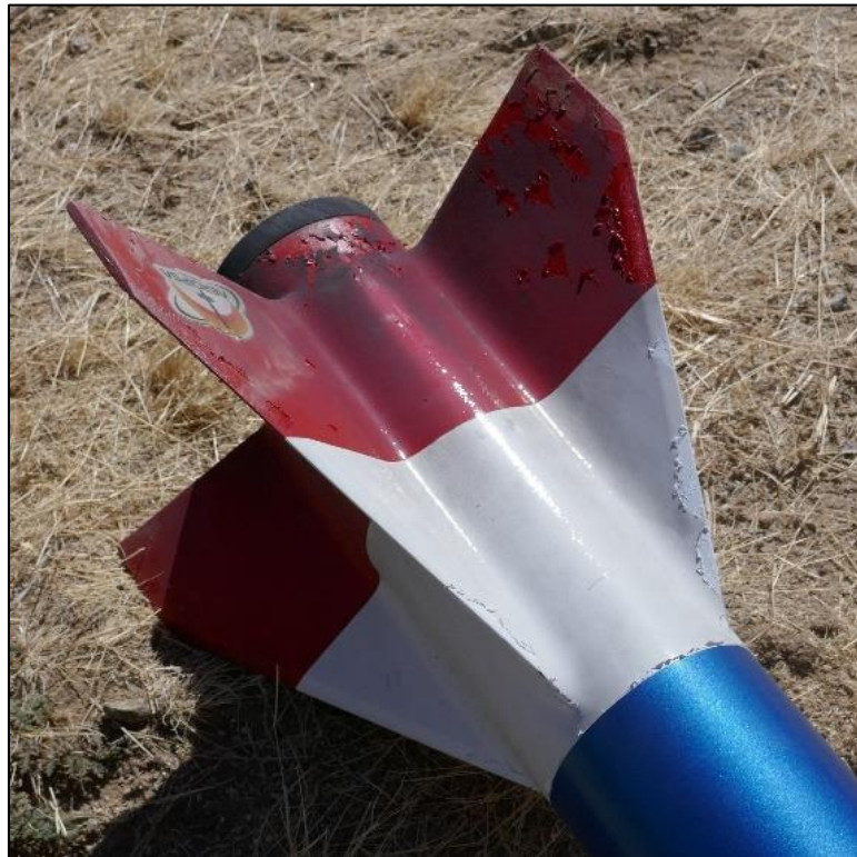
Figure 1 : Dégradation de l'état de surface des ailerons de Fast Forward.
