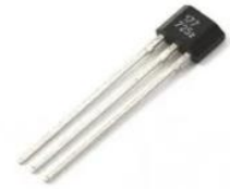
Figure 25 - Capteur à effet Hall
