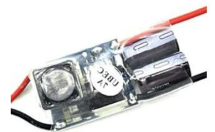
Figure 2 - Régulateur UBEC 5V 7A
