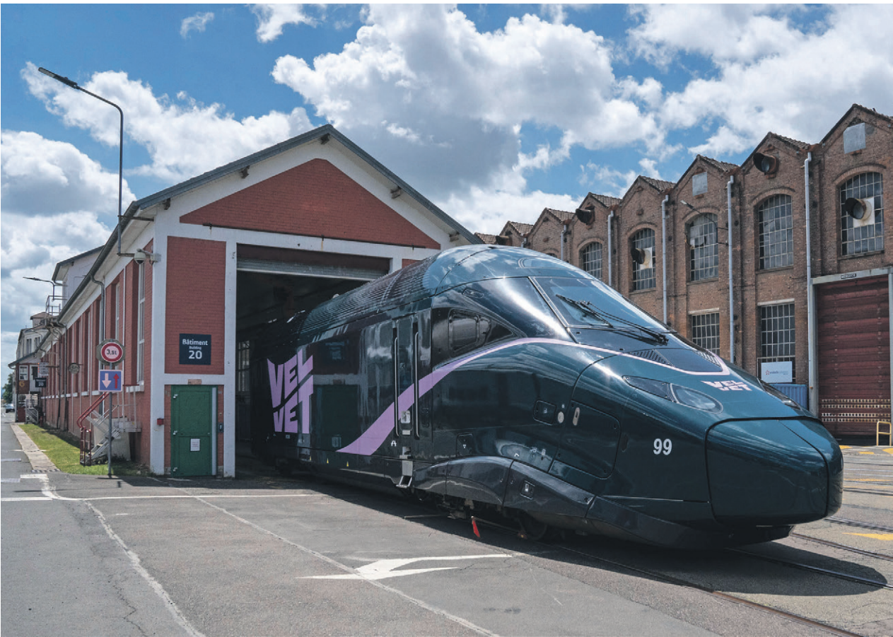
Pour ses douze trains, l'opérateur Velvet a opté pour l'Avelia Horizon. Le dernier-né d'Alstom circule à plus de 300 km/h, transporte plus de passagers que le modèle précédent et consomme 20 % d'énergie en moins.
